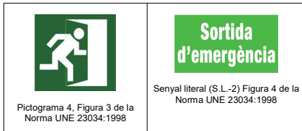
Figura 2: Pictograma i senyal literal per senyalitzar sortides d'emergència d'acord Norma UNE 23-034-88
